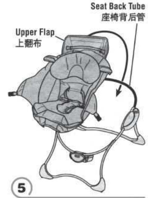
Enfiler le « upper flap », = le rabat supérieur du coussin de siège sur support partie arrière.
