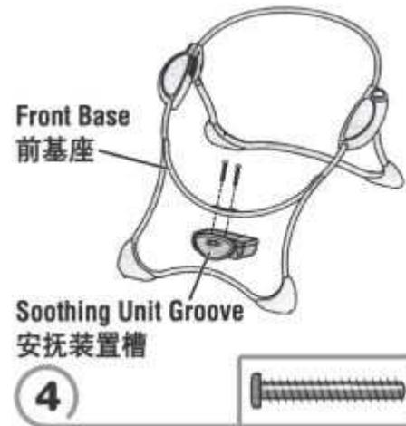
Fixer l'unité de contrôle avec les deux dernières vis 30 MM sur la partie support avant
