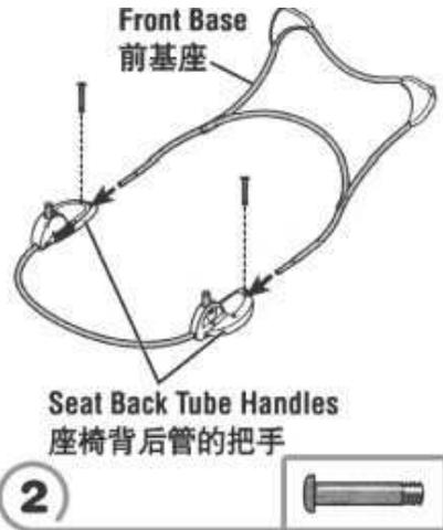
Enfoncer le support partie avant dans le support partie arrière et Placer les deux plus petites vis 20 mm
