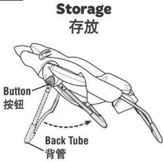
« Button » ; presser le bouton pour permettre la fermeture du support et faciliter son rangement
